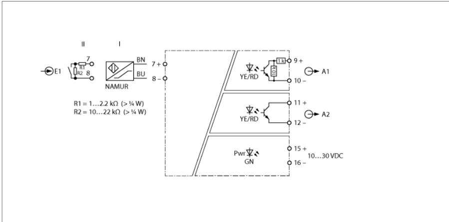
К повторителю IM12-DI03-1S-1NAM1T-PR/24VDC/CC NAMUR могут быть подключены датчики, соответствующие EN 60947-5-6 (NAMUR), или беспотенциальные контакты. Данное устройство можно установить в зоне 2. Выходная цепь оснащена 1 дополнительным транзисторным выходом. Устройство отвечает требованиям NE21.
