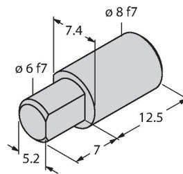
Адаптер для специальных позиционирующих элементов RI-QR14, полый, на сплошной вал, Ø 8 мм
