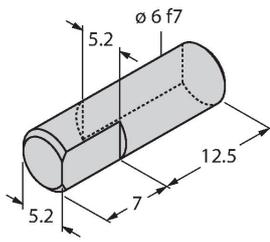
Адаптер для специальных позиционирующих элементов RI-QR14, полый, на сплошной вал, Ø 6 мм
