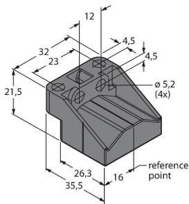
Плавающий позиционирующий элемент для LI-Q25L; для работы со смещением 90°; номинальная дистанция до датчика 1,5 мм; спаривание с датчиком на дистанции до 5 мм; допустимый зазор до 4 мм
