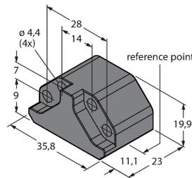
Плавающий позиционирующий элемент для датчиков линейного перемещения LI-Q25L; номинальная дистанция до датчика 1,5 мм; спаривание с датчиком на дистанции до 5 мм или допустимый зазор до 4 мм.
