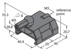
Направляемый позиционирующий элемент для датчиков линейного перемещения LI-Q25L, вставляется в паз датчика
