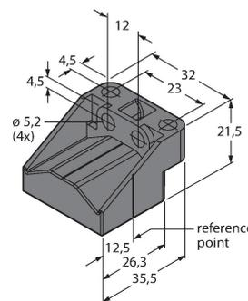
Плавающий позиционирующий элемент для датчиков линейного перемещения LI-Q25L; номинальная дистанция до датчика 1,5 мм; спаривание с датчиком на дистанции до 5 мм или допустимый зазор до 4 мм.
