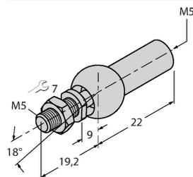
Осевое соединение для позиционирующего элемента
