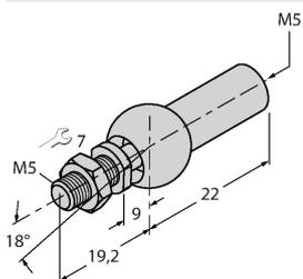
Осевое соединение для позиционирующего элемента, нерж. сталь
