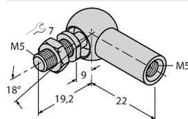
Угловое соединение для позиционирующего элемента, нерж. сталь
