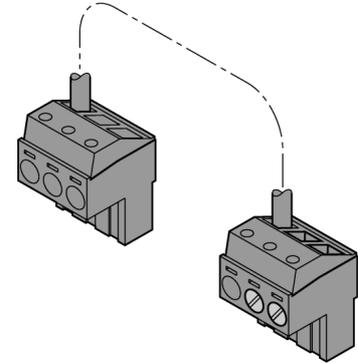
Pour la mesure de températures par des thermocouples, la température du point de référence devrait être connue la plus précise que possible. Le IM-3-CJT offre cette possibilité.
