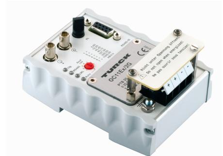
Le coupleur fibre optique OC11Ex/2G.2 convertit les signaux PROFIBUS-DP de lignes de cuivre en fibre optique. Les signaux de bus peuvent ainsi être transmis de la zone sûre à la zone Ex libre de potentiel et antiparasite sur de grandes distances. La portée maximale de transmission est de 2 500 m avec un câble fibre optique OM1 (62,5/125 µm) et de 1 500 m avec un câble fibre optique OM2 (50/125 µm).
