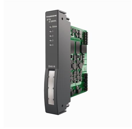
Le module d'entrée DI40-N sert de la connexion de détecteurs suivant NAMUR (DIN EN 60947-5-6), de détecteurs 3 fils (NPN, PNP), ou de contacts mécaniques.
