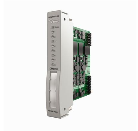
Le module d'entrée/sortie DM80Ex sert de la connexion de détecteurs NAMUR (DIN EN 60 947-5-6) et d'actuateurs. Si la surveillance aux ruptures de câble ou aux courts-circuits est activée et que l'on utilise des contacts mécaniques, ces contacts doivent être équipés de résistances (WM1, n° d'identité).
