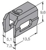
Pièce de serrage pour le montage de détecteurs de champs magnétiques sur des vérins à rainure en queue d'aronde ; largeur de rainure : 7,35 mm ; matériau : PPS
