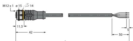
Câble de raccordement, connecteur femelle M12, droit, 4 broches, longueur de câble : 2 m, matériau de la gaine : PUR, noir ; homologation cULus
