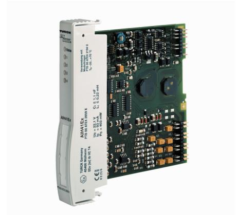
El módulo de entrada AIH41Ex sirve para conectar transductores de cuatro conductores (entrada pasiva = no alimentando / transmisor activo).
