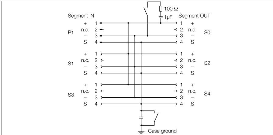
El módulo de distribución para Ex de cuatro canales, tipo JBBS-48-M413/EX, está diseñado para el PROFIBUS-PA.
