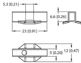
Soporte de montaje para montar sensores de campo magnético en cilindros redondos
