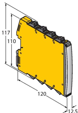
Amplificador-aislador; dos canales; SIL2 conforme a IEC 61508; modelo Ex; 2 salidas de transistor; entrada señal Namur; control desconectable de rotura de hilo y cortocircuito; conmutable entre modo de corriente de trabajo y reposo; duplicación de señal; bornes roscados extraíbles; ancho 12,5 mm; tensión de alimentación de 24VDC
