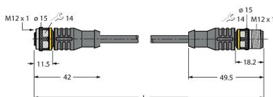
Cable de extensión, conector hembra M12, recto, de 3 polos a conector macho M12, recto, de 3 polos; longitud del cable: 2 m; material de revestimiento: PUR, negro; aprobación cULus
