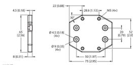
Placa adaptadora para el montaje de la carcasa QR20 con orificios de montaje para la carcasa Q20L60
