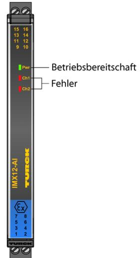
Über den 2-kanaligen HART®-Messumformer-Speisetrenner IMX12-AI01-2I-2IU-H0/24VDC werden eigensichere HART®-2-Draht-Messumformer im Ex-Bereich betrieben und die Messsignale in den Nicht-Ex-Bereich übertragen.
