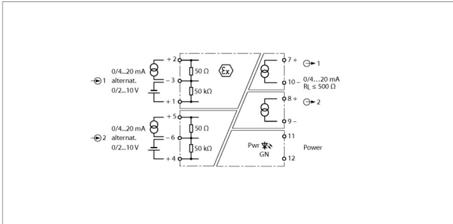
Über den 2-kanaligen Analogsignaltrenner IM31-22EX-I werden normierte, aktive Spannungs- oder Stromsignale galvanisch getrennt aus dem Ex-Bereich in den Nicht-Ex-Bereich übertragen.
