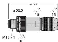
Konfektionierbarer Stecker, M12 x 1, gerade, 5-polig, Schraubklemmanschluss, Leitungsdurchlass 6.0 bis 8.0 mm, Adernquerschnitt/Klemmvermögen 0.14 bis 0.75 mm<sup>2</sup>, Metallgehäuse, Metallüberwurfmutter, schirmbar
