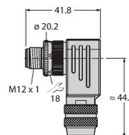
Konfektionierbarer Stecker, M12 x 1, gewinkelt, 5-polig, Schraubklemmanschluss, Leitungsdurchlass 6.0 bis 8.0 mm, Adernquerschnitt/Klemmvermögen 0.14 bis 0.75 mm<sup>2</sup>, Metallgehäuse, Metallüberwurfmutter, schirmbar
