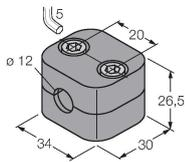
Befestigungsschelle für Glatt- und Gewinderohrsensoren; Werkstoff: Polypropylen
