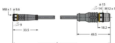
Verbindungsleitung, M8-Kupplung, gerade, 4-polig auf M12-Stecker, gerade, 4-polig, Leitungslänge: 2 m, Mantelmaterial: PUR, schwarz; cULus-Zulassung
