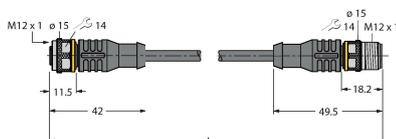
Verbindungsleitung, M12-Kupplung, gerade, 3-polig auf M12-Stecker, gerade, 3-polig; Leitungslänge: 2 m, Mantelmaterial: PUR, schwarz; cULus-Zulassung
