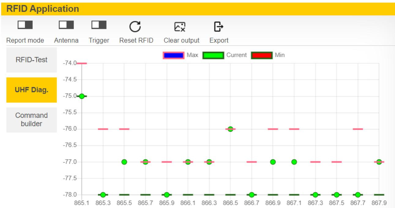
Abb. 123: Beispiel UHF-Diagnose: empfangener Leistungspegel pro Kanal
