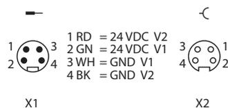
Abb. 13: TBEN-L4... – Pinbelegung Versorgungsspannungsanschlüsse
