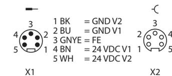
Abb. 14: TBEN-L5... – Pinbelegung Versorgungsspannungsanschlüsse
