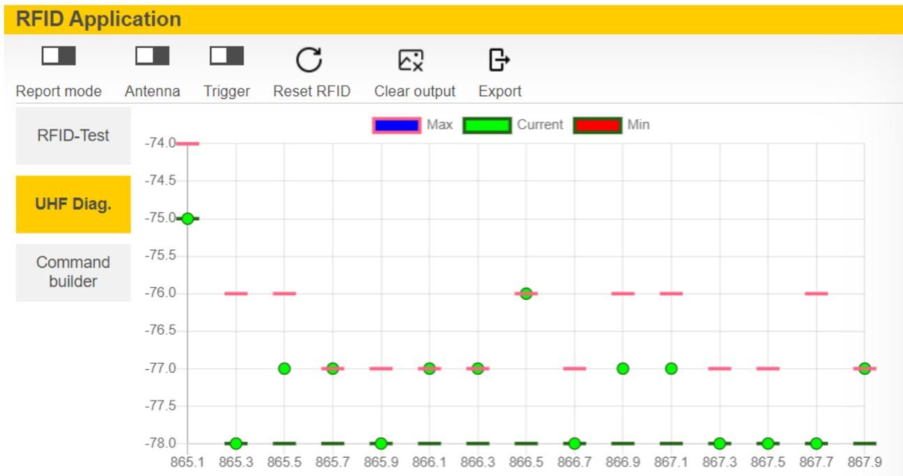
Abb. 62: Beispiel UHF-Diagnose: Empfangener Leistungspegel pro Kanal
